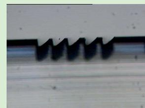
präzise Sägezahnstrukturen (erzeugt mittels UV-Laser)
