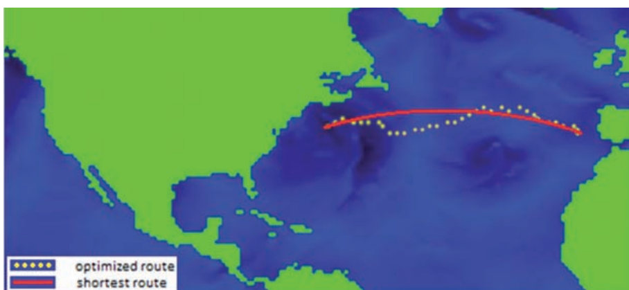
Abb. 3: Ergebnis der A*-Routenoptimierung (rot = Großkreis, gelbe Punkte = Wegpunkte der optimierten Route)
