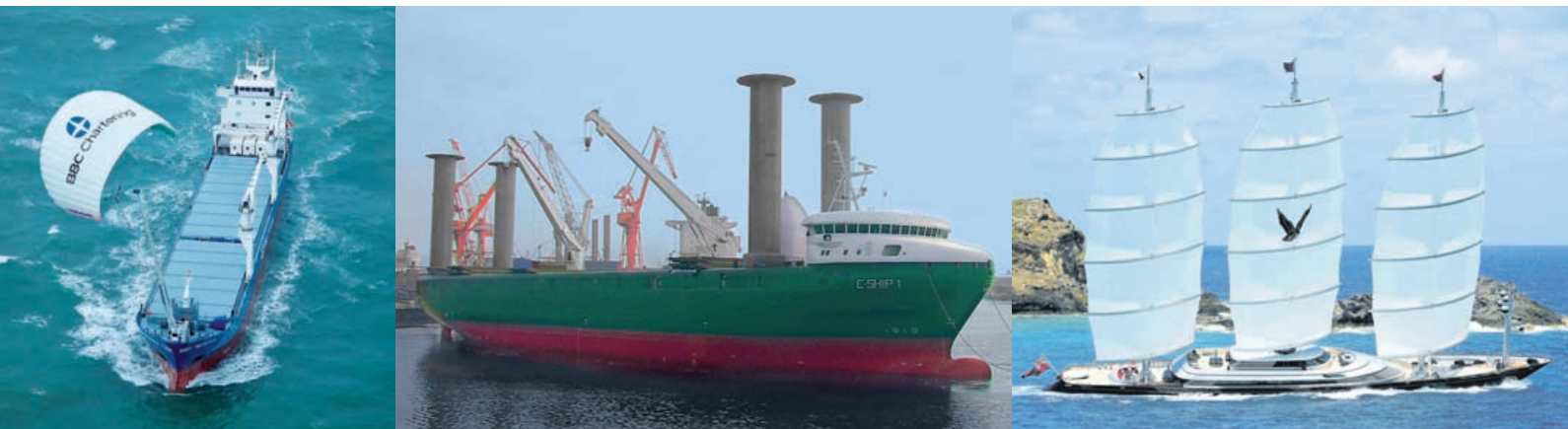
Abb. 2: Die betrachteten Windzusatzantriebe Kite, Flettner-Antrieb und Dynarigg
