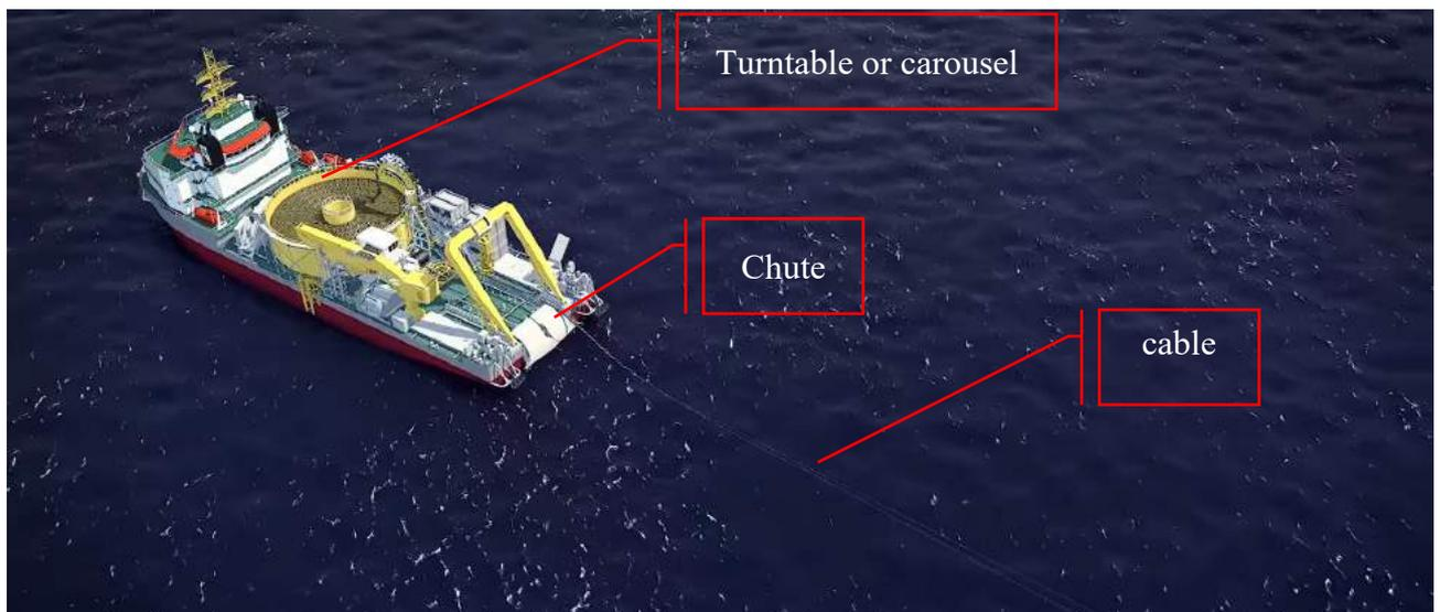
*Figure 6-192 Cable Laying Vessel (Boskalis 2017)<sup>75</sup>*
