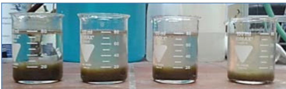
Abbildung 4: Trübung und absetzbare Feststoffe vor und nach Beschallung - von links: abgesetzter Schlamm nach 0, 15, 30 und 60
