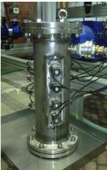
**Abbildung 30: Erster Ultraschall-Testreaktor [22]**
