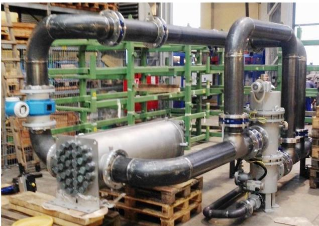
**Abbildung 49: Roh-Aufbau UV-Reaktor, Filter und Piping des 250 m<sup>3</sup>/h Prototyps [22]**
