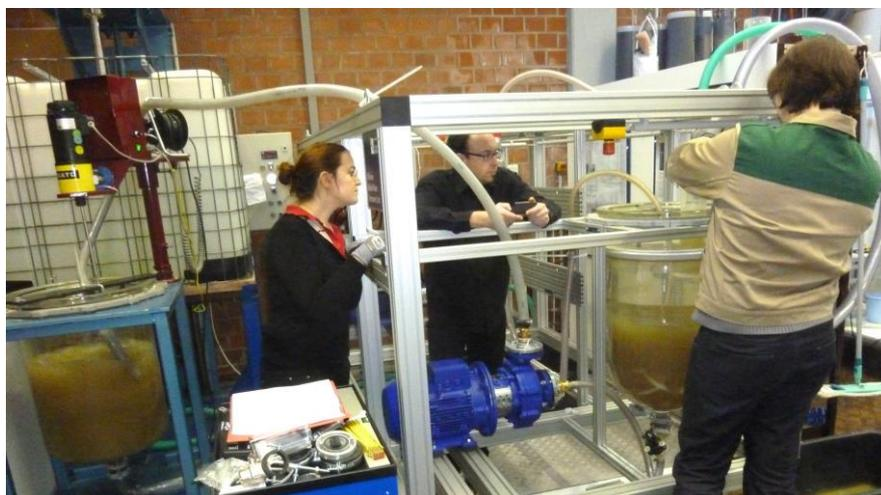
**Abbildung 15: Mobiles Pilotmodul für Tests der einzelnen Behandlungsstufen**
