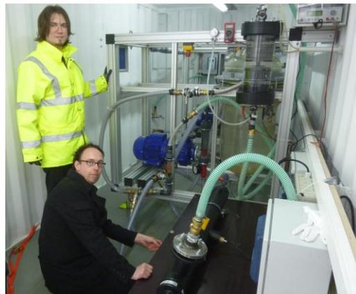
**Abbildung 44: UV- u. Elektrolyse-Module (rechts) als zwei Optionen der 2. Behandlungsstufe [16]**
