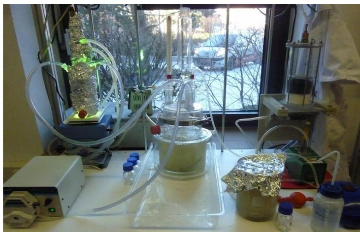
**Abbildung 10: Testanordnung zur Filtration und UV-Desinfektion ausgewählter Realmedien [22]**
