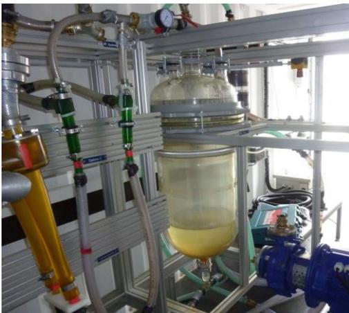
**Abbildung 43: Hydrozyklone, erste Stufe der Ballastwasserbehandlung [16]**
