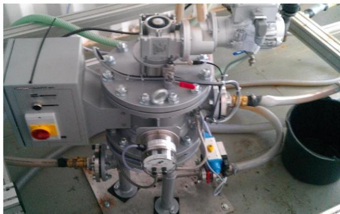
**Abbildung 22: 50 µm-Patronen-Pilotmodul der Fa. Hydac [22]**
