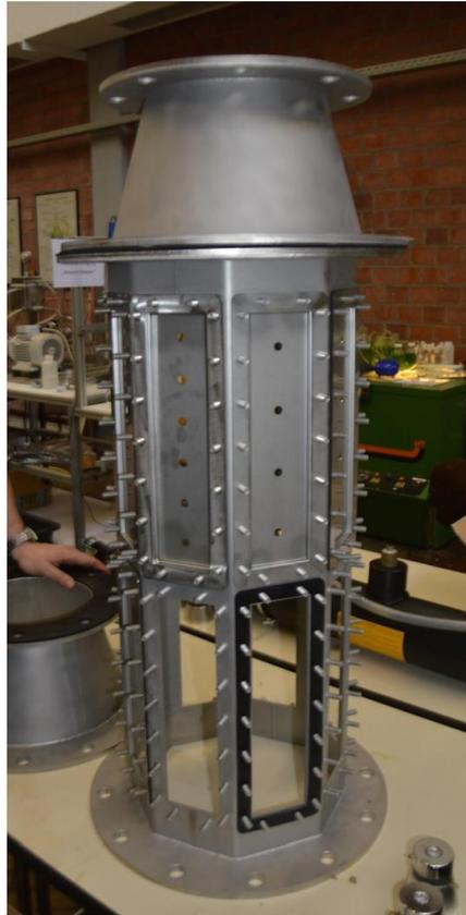
**Abbildung 36: Der kompakte oktogonale 4. Hochleistungs-Ultraschallreaktor-Prototyp [22]**
