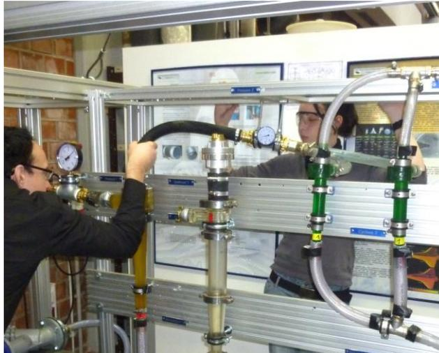
**Abbildung 21: Testvorrichtung mit drei Hydrozyklonen [22]**
