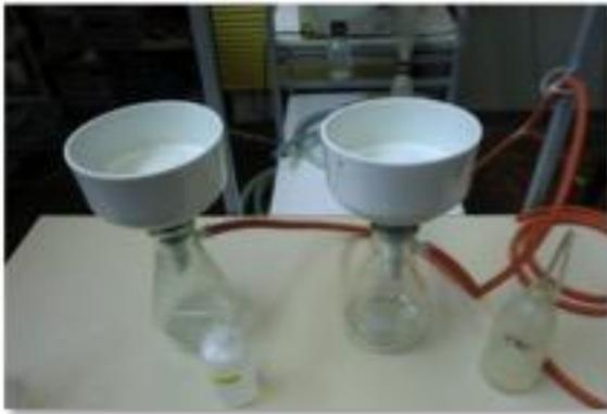
**Abbildung 16: Gravimetrische Bestimmung des Feststoffgehalts [15]**
