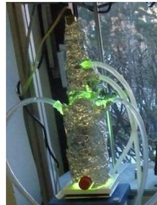
**Abbildung 12: Labor-UV-Desinfektionsanlage zur Elimination von Bakterien [22]**
