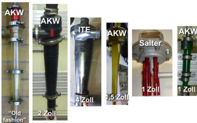
**Abbildung 11: Auswahl getesteter Hydrozyklone, die zur Plankton Separation getestet wurden [14; 22]**
