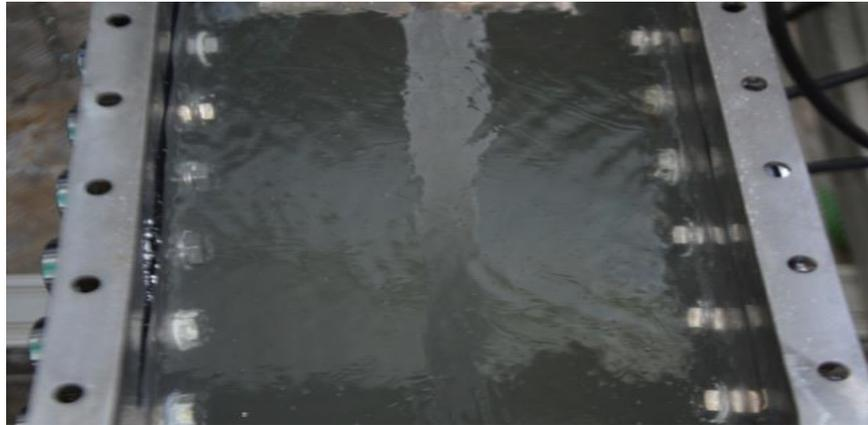
**Abbildung 29: Ultraschall-Testzelle zur Verifikation der modellmäßig simulierten Schallausbreitung der in Abbildung 28 dargestellten Ergebnisse [22]**
