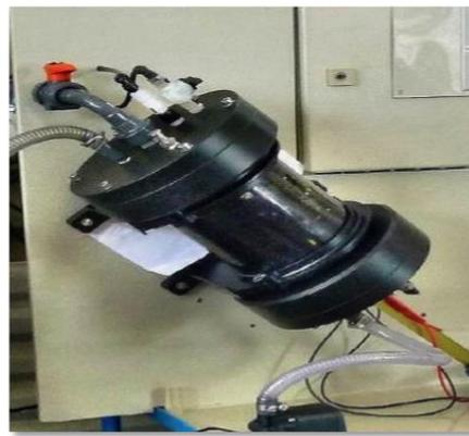
**Abbildung 38: 1,5 m<sup>3</sup>/h Seewasser-Elektrolyse der Fa. Südchemie [17]**
