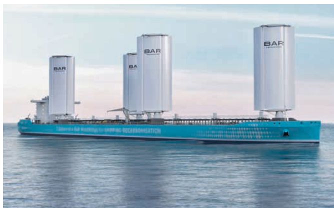
Frachtschiffkonzept von Deltamarin mit modernen BAR-Wingsails
