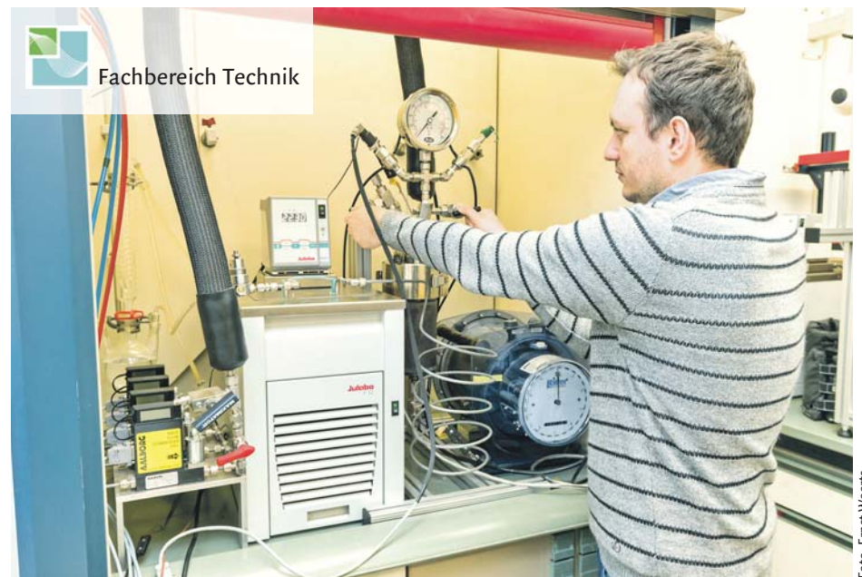
Der aus Windstrom erzeugte Wasserstoff wird an dieser Versuchsanlage in Methan umgewandelt und kann dann im Erdgasnetz gespeichert werden.
